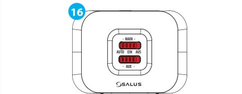
**Hinweis:** Der Empfänger kann als Kesselferschalter oder Zonenventilregler konfiguriert werden. Er bietet einen Zweikanalausgang. Der erste Kanal (Hauptausgang) kann mit mehreren Smart TRV bis zu einem Maximum von 16 Einheiten für eine Wärmebedarfsfunktion gepaart werden.
